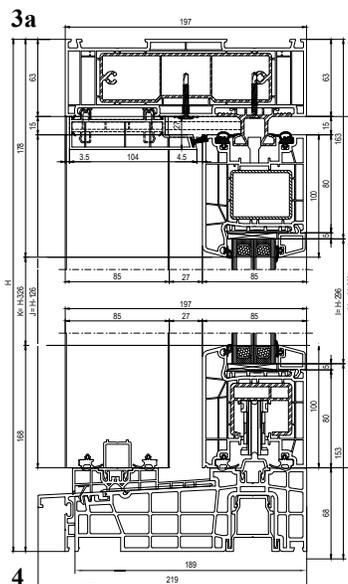
spessore telaio 197 mm
