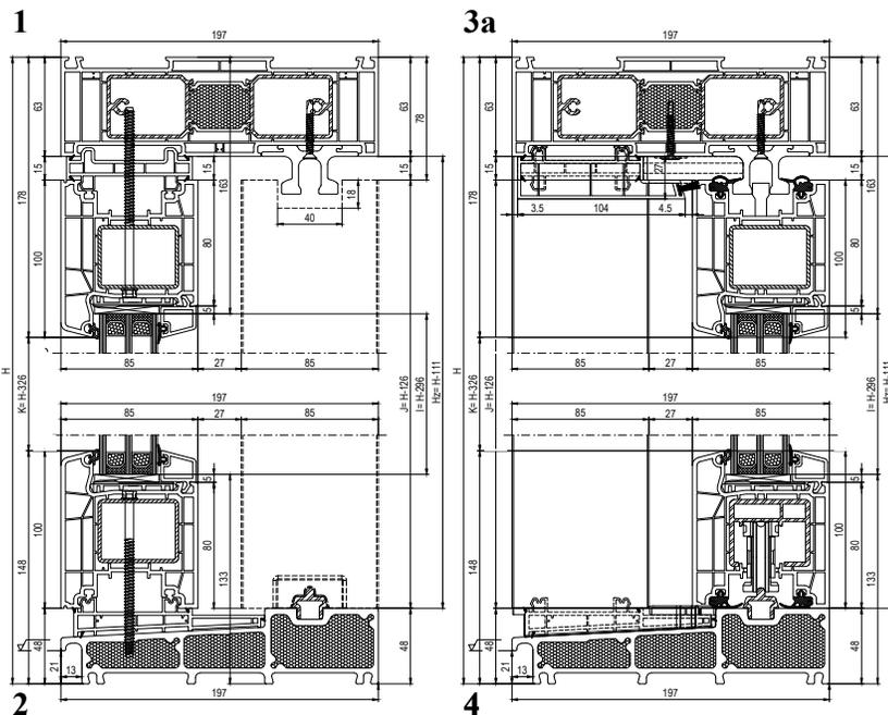
spessore telaio 197 mm
